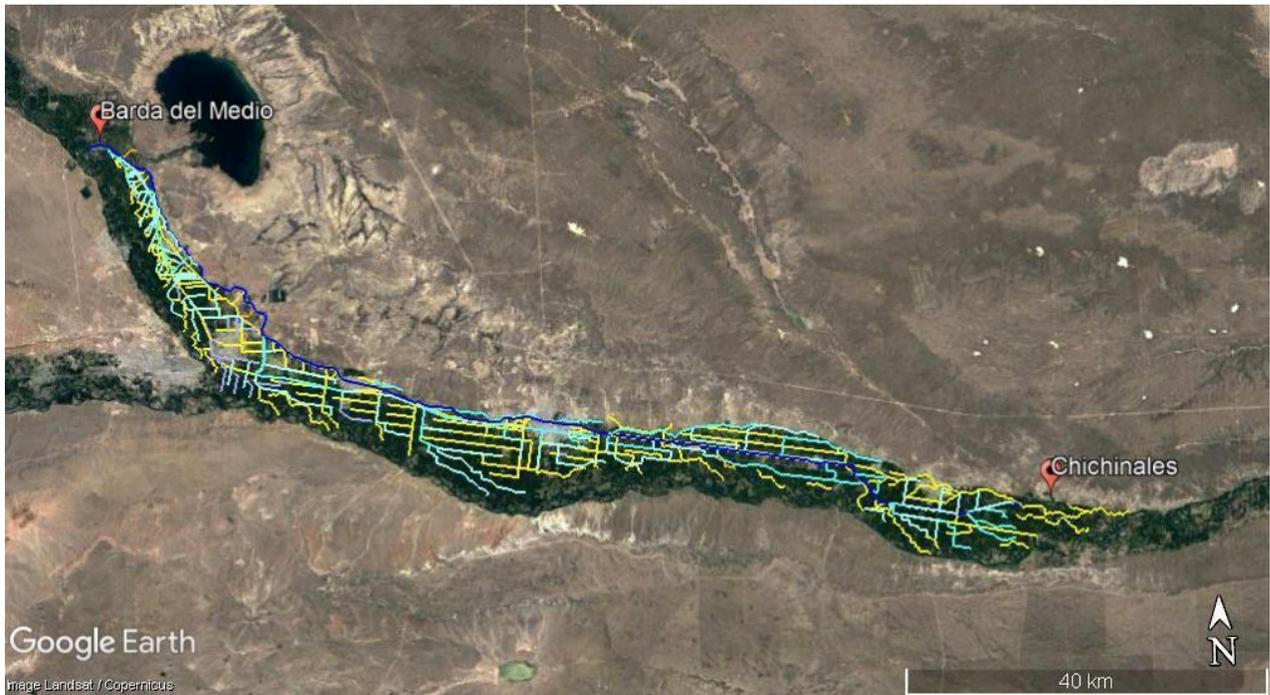
*Figura 1. Red de riego y drenaje del Sistema Integral de Riego del Alto Valle.*
